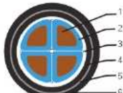
1kV 4芯铠装电缆( \geq 50\text{mm}^2 )
