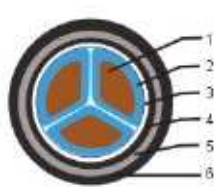
1kV 3芯铠装电缆( \geq 50\text{mm}^2 )
